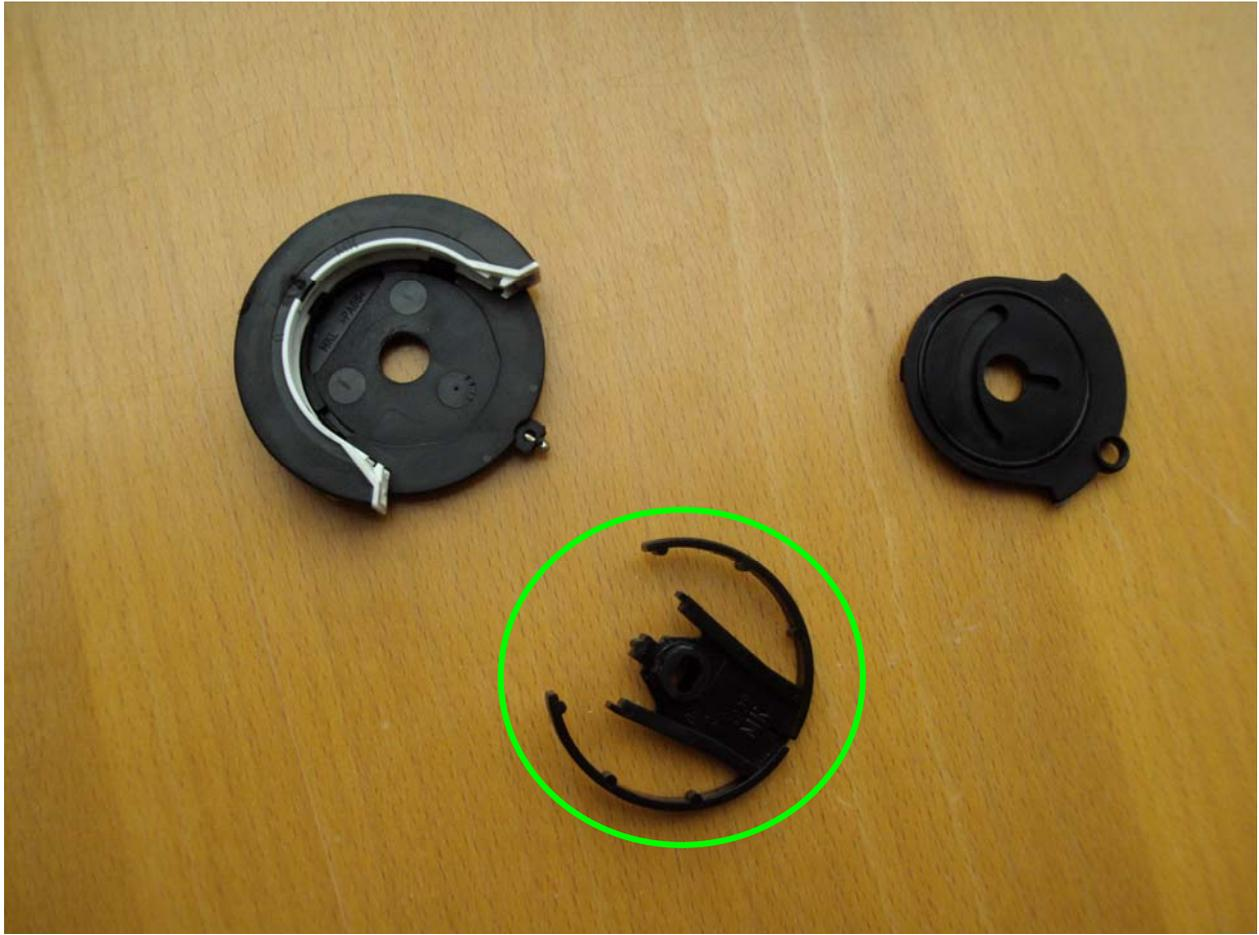
In der Mitte ist der Beleuchtungsträger ersichtlich, auch hier habe ich wieder mit 2 LED's gearbeitet die auf einem kleinen Print gelötet sind, der Vorwiderstand ist aus Platzgründen ausserhalb des Gehäuses plaziert und angelötet.
